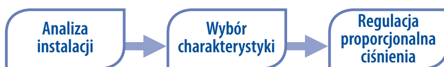
Rys. 1. Struktura algorytmu AUTOADAPT. Algorytm składa się z trzech zadań. Są to: analiza, dobór i regulacja.
