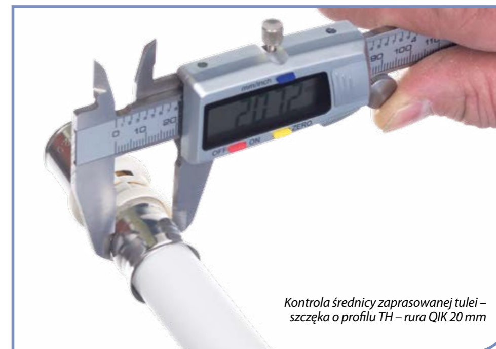
Kontrola średnicy zaprasowanej tulei – szczęka o profilu U i H – rura QIK 20 mm
